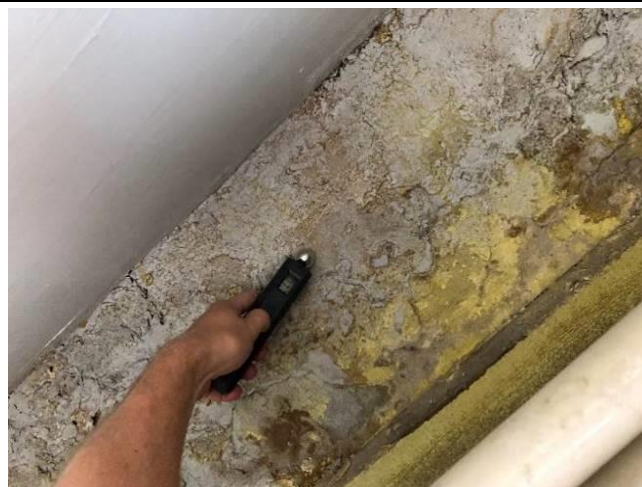
Foto Nr. 91 Ārsienas apdares bojājumi mitruma migrācijas ietekmē. Foto Nr. 92 Mitrums ārsienas konstrukcijā 3.2%CM.(rād. Vid.75).
