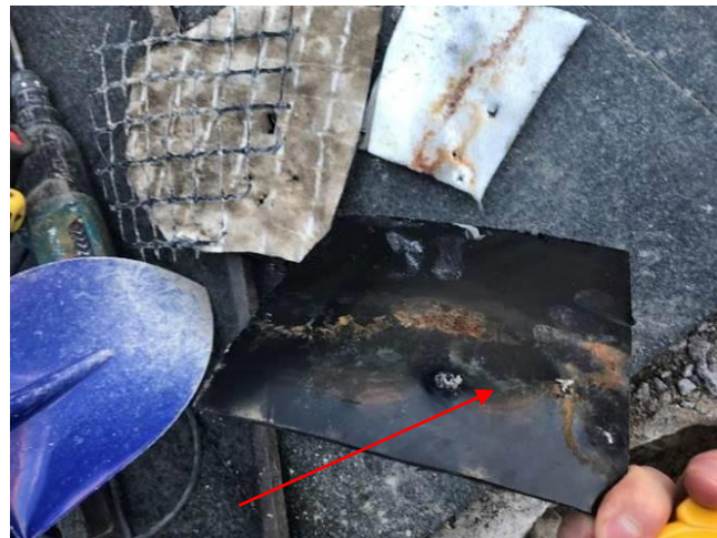
Foto Nr. 62 Virs pārseguma konstrukcijas ieklāta HDP membrāna
