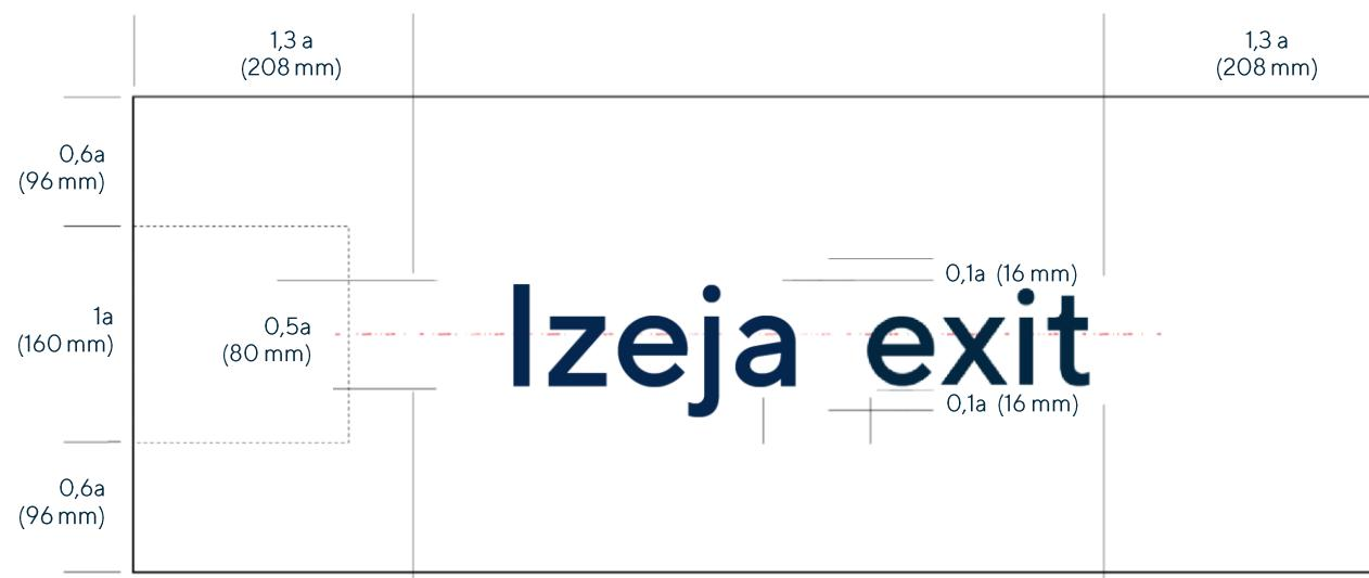
Pasažieru platformas un sliežu ceļu norādes tiek veidotas pēc standarta virzienu zīmju principiem, pikogrammu aizvietojot ar ceļa vai platformas numuru.
