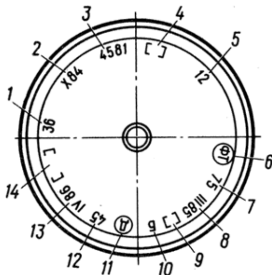
27.zīm. Zīmes un spiedzīmes ass labajā galā dīzeļlokomotīvu riteņpāriem ar ārējiem bukšu kakliņiem un gala slīdbalstiem.
