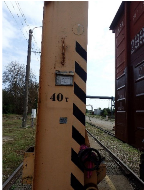
6. att. Elektrodomkrats DT-40 ar vadības skapi (2 gabali). Vagona pacelšanas pozīcija uz ceļa Nr. 58. SAP Nr. 242000014186-0000
