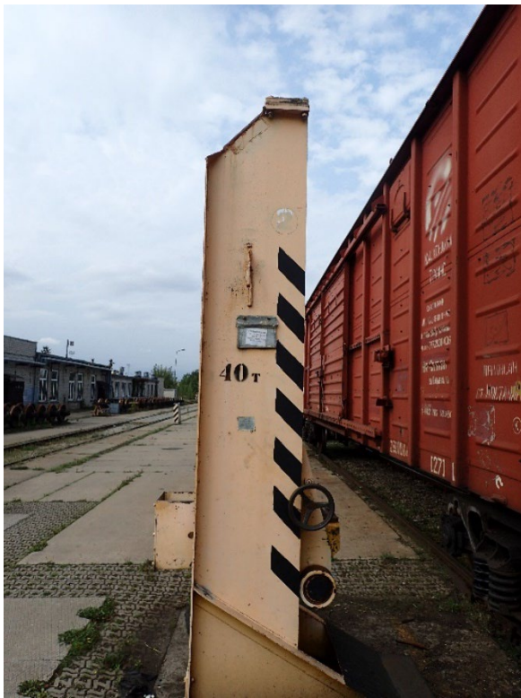
6. att. Elektrodomkrats DT-40 ar vadības skapi (2 gabali). Vagona pacelšanas pozīcija uz ceļa Nr. 58. SAP Nr. 242000014186-0000
