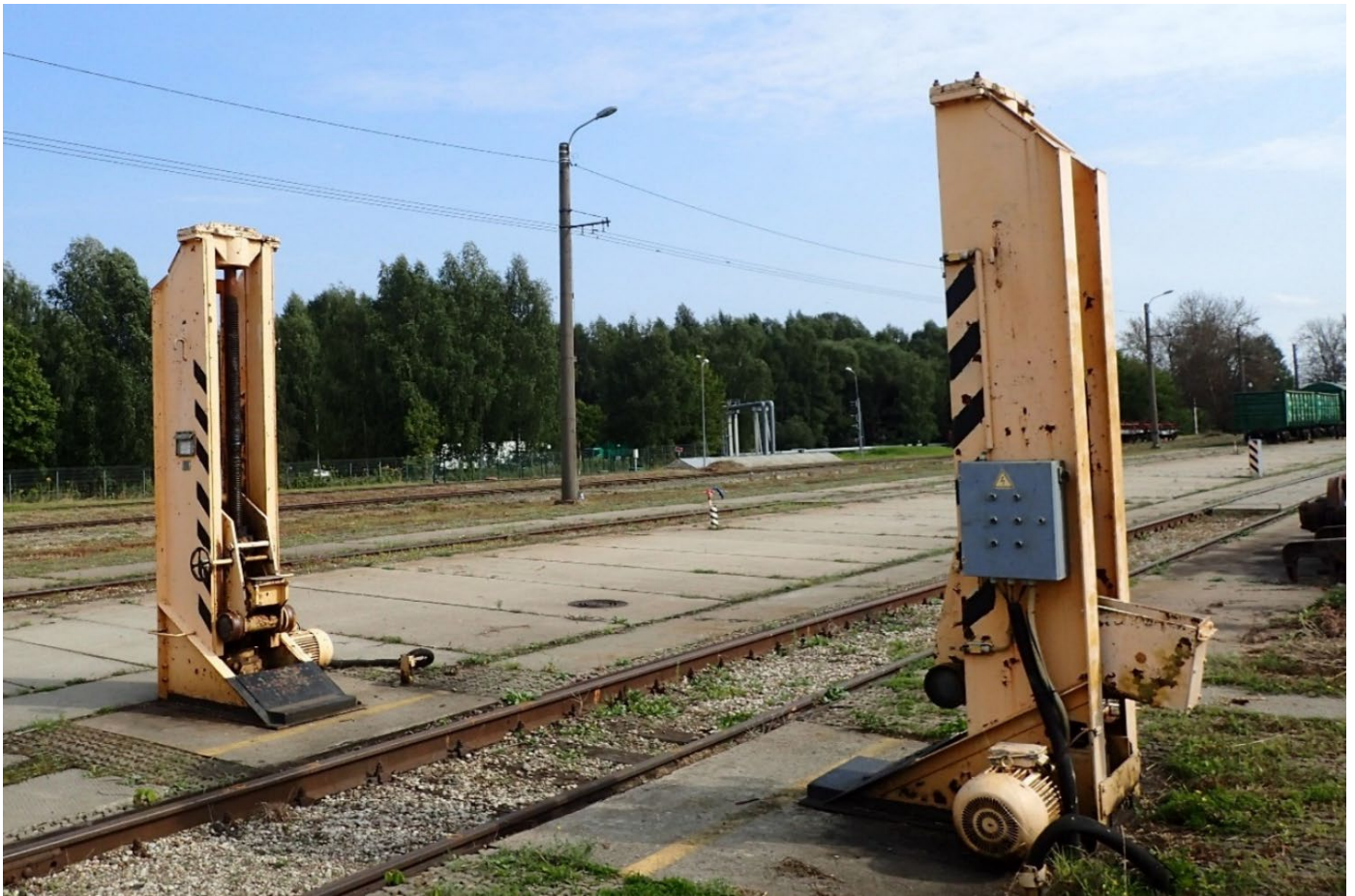
4. att. Elektrodomkratu komplekts DT-40 (2 gabali). Vagona pacelšanas pozīcija uz ceļa Nr. 57. SAP Nr. 242000005959-0000
