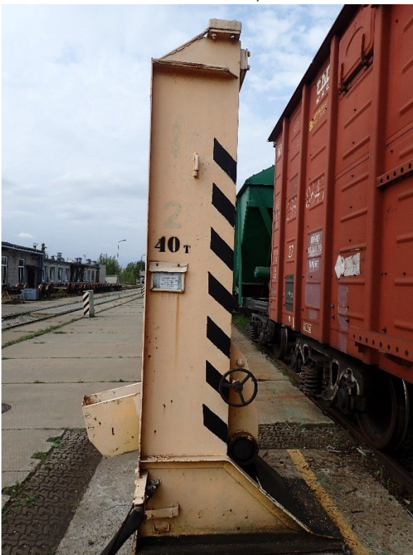
7. att. Elektrodomkrats DT-40 (2 gabali). Vagona pacelšanas pozīcija uz ceļa Nr. 58. SAP Nr. 242000014187-0000
