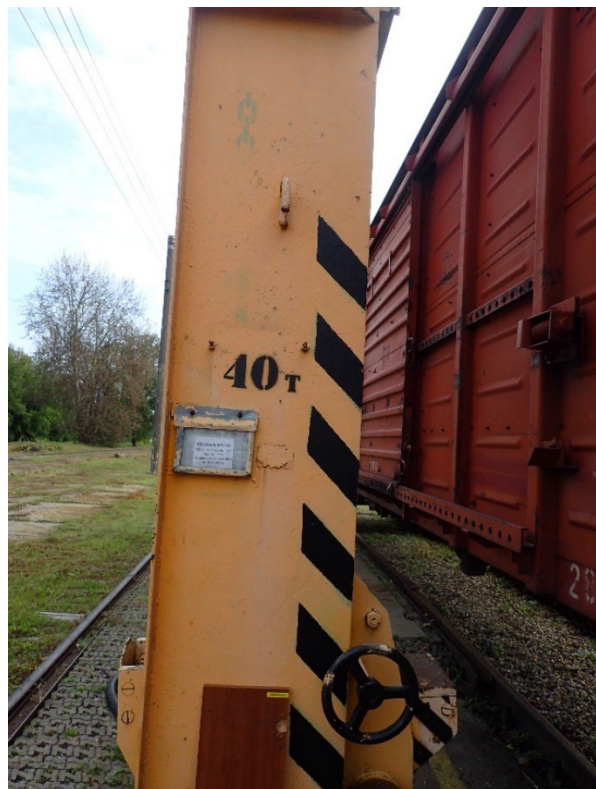
7. att. Elektrodomkrats DT-40 (2 gabali). Vagona pacelšanas pozīcija uz ceļa Nr. 58. SAP Nr. 242000014187-0000
