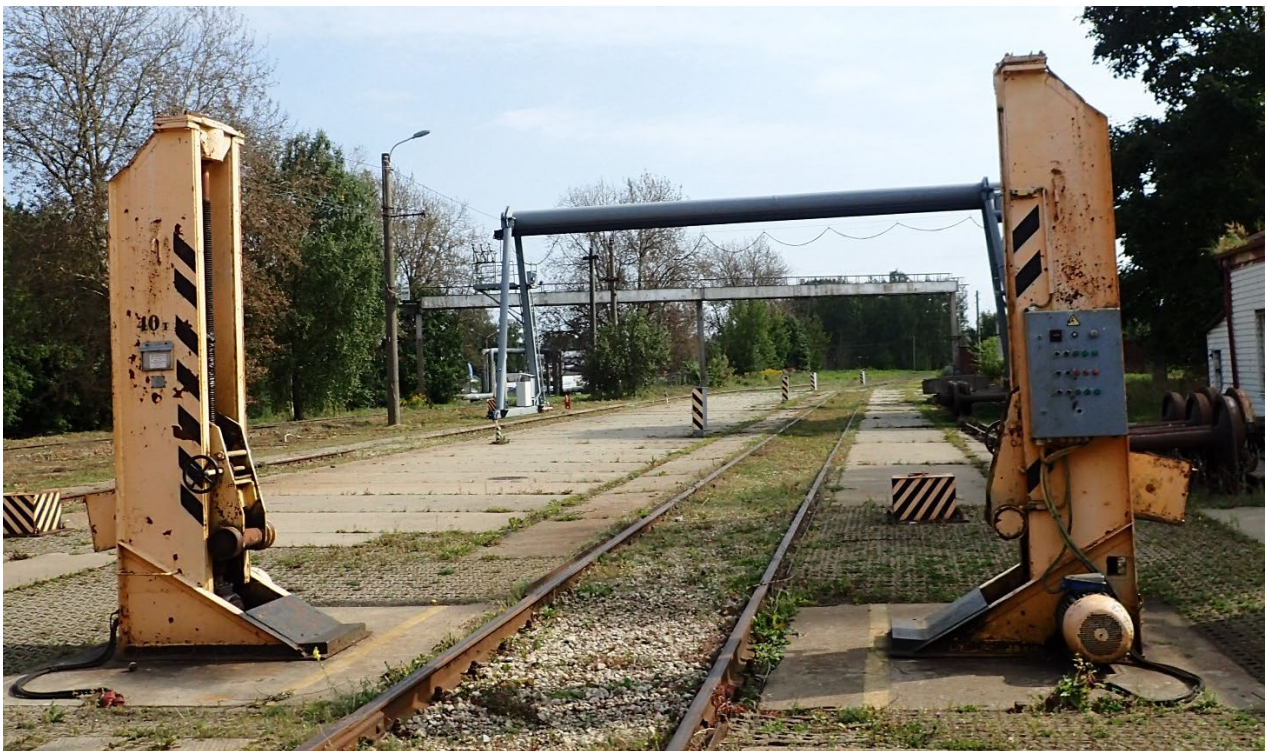
5. att. Elektrodomkratu komplekts DT-40 (2 gabali). Vagona pacelšanas pozīcija uz ceļa Nr. 57. SAP Nr. 242000005959-0000
