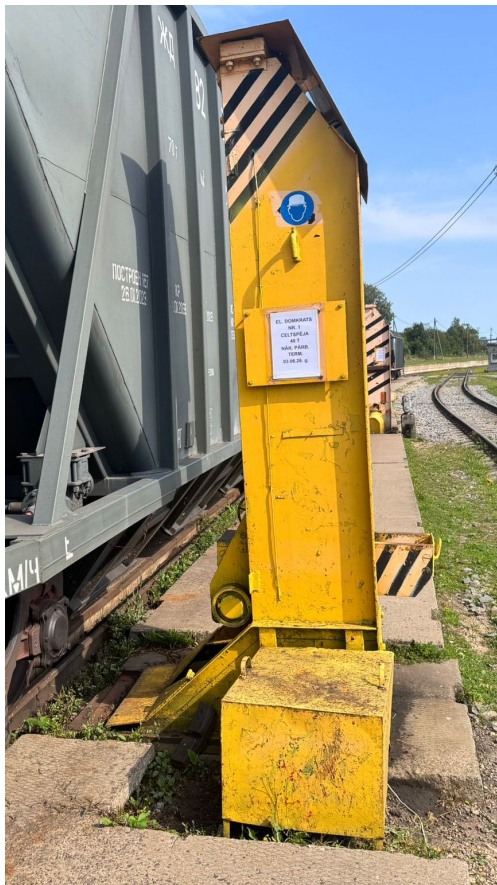
3. att. DT-40 elektrodomkrati (2 gabali). Vagona pacelšanas pozīcija uz ceļa Nr. 26. SAP Nr. 442000007418-0001, 442000007418-0002
