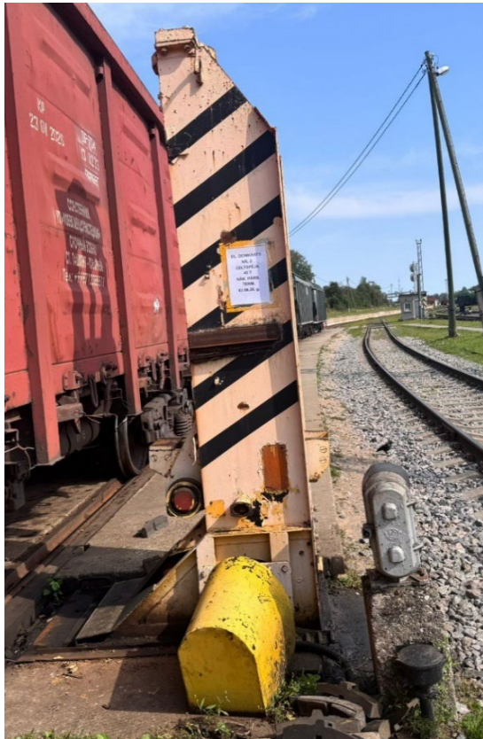
4. att. TED-40 elektrodomkrati (2 gabali). Vagona pacelšanas pozīcija uz ceļa Nr. 26. SAP Nr. 242000000633-0000, 242000000634-0000
