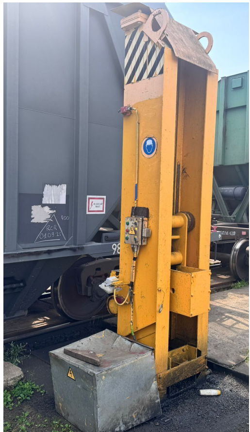
3. att. DT-40 elektrodomkrati (2 gabali). Vagona pacelšanas pozīcija uz ceļa Nr. 26. SAP Nr. 442000007418-0001, 442000007418-0002
