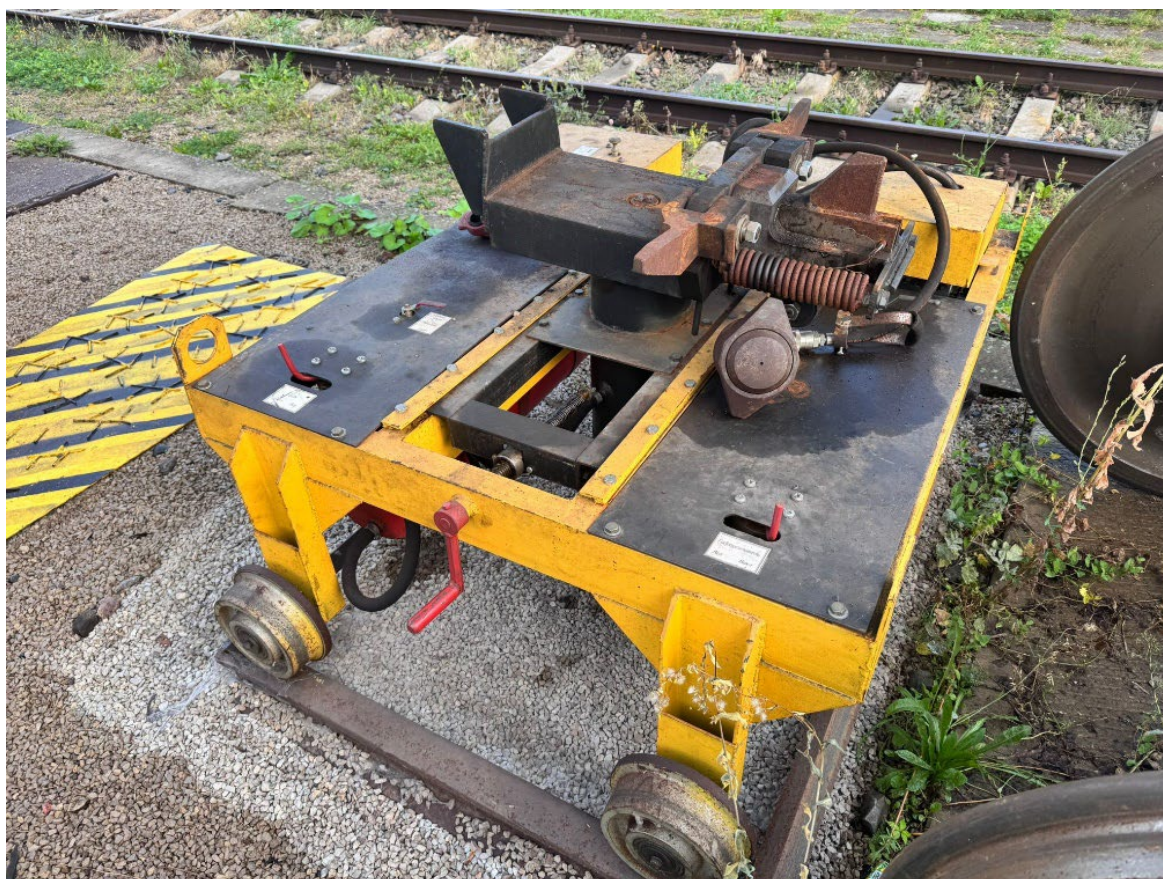
8. att. Slāpētāja aparāta noņemšanas ierīce, SAP Nr. 460000011428-0000
