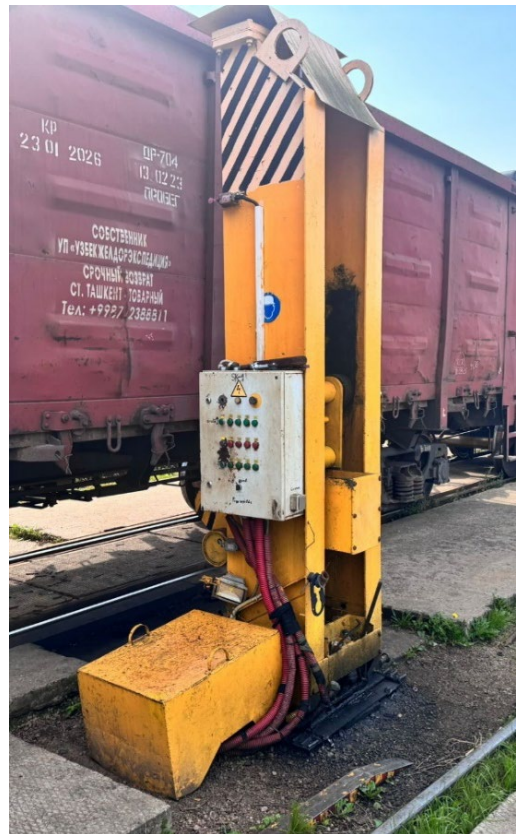
4. att. TED-40 elektrodomkrati (2 gabali). Vagona pacelšanas pozīcija uz ceļa Nr. 26. SAP Nr. 242000000633-0000, 242000000634-0000
