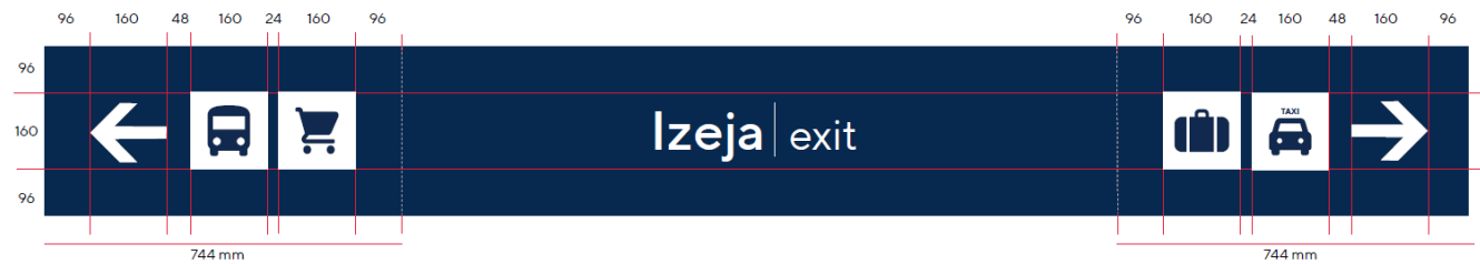
Raksturīgie izmēra nosacījumi vairāku līniju zīmei (mm)
