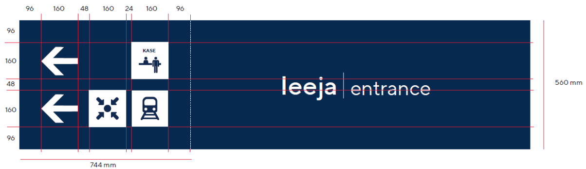
Raksturīgie sliežu ceļu virzienu zīmes izmēri (mm)
