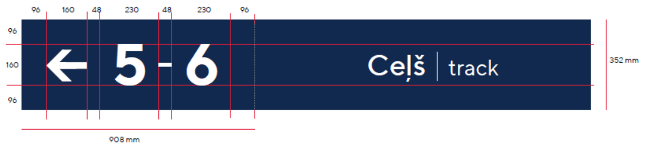
Raksturīgie sliežu ceļu virzienu zīmes izmēri (mm)
