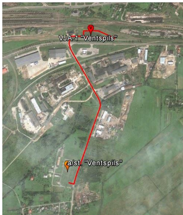
4.attēls. VJA-1 Ventspils pieslēgums pie elektrotīkla.Avots: LDZ
