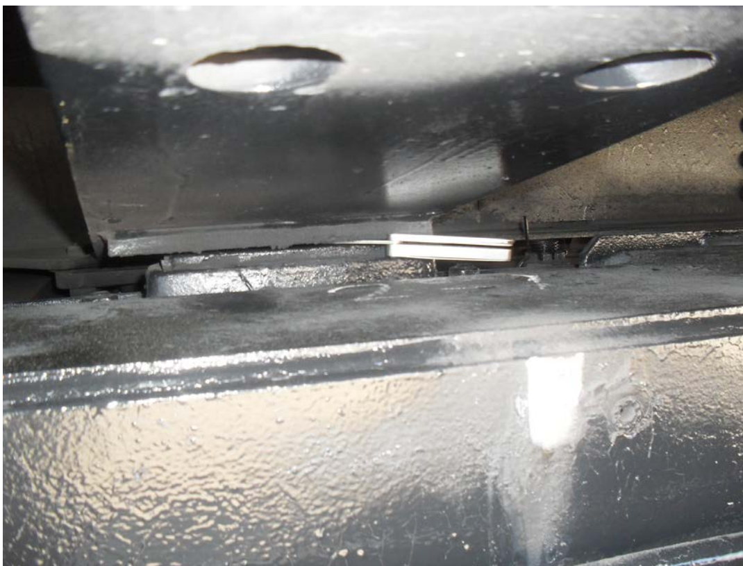
Рисунок 3 – Суммарный зазор между горизонтальными скользящими с обеих сторон тележек КВЗ-И2 и ЦМВ Дессау - не более 6 или не менее 2 мм
