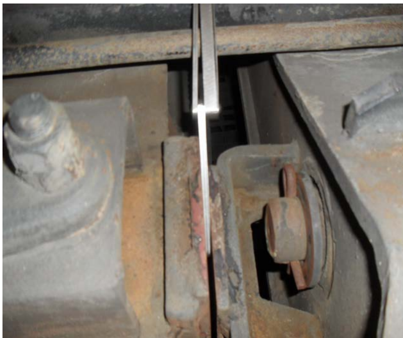
Рисунок 4 – Суммарный зазор между вертикальными скользящими (с одной стороны у тележки) у тележки типа ЦМВ Дессау - не более 16 мм
