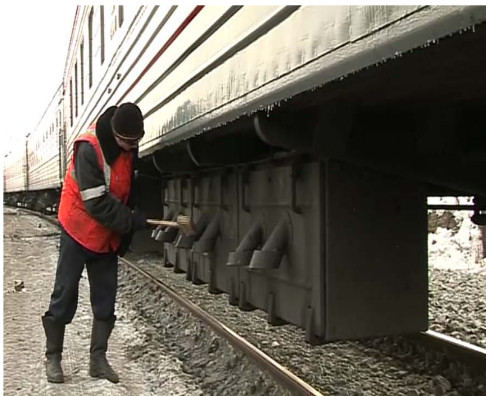
Рисунок Б.11 - Очистка дефлекторов ящиков аккумуляторных батарей, в соответствии с п.п.2.4 и 3.7
