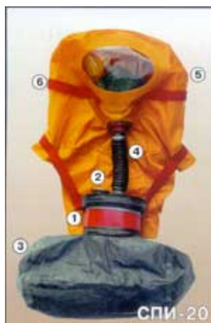
Рис. Е.1 - Устройство самоспасателя промышленного изолирующего СПИ-20
