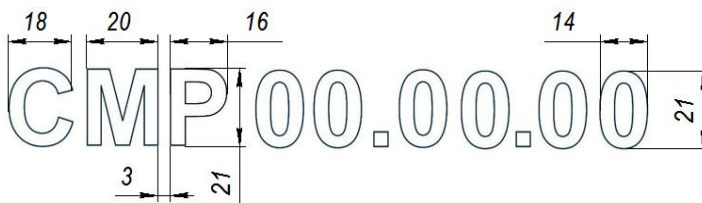
Рисунок 1 – Надпись следующего срока смены масла редуктора
