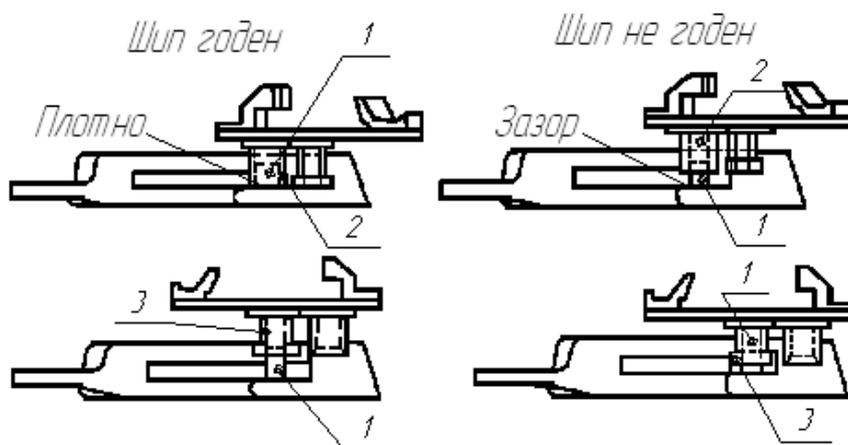
Рисунок 2.25 - Проверка диаметра шипа замка шаблоном 833
