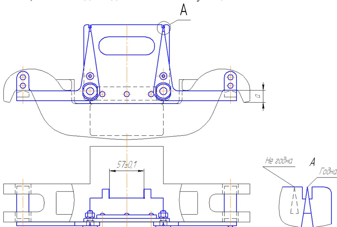
Рисунок 2.67 - Проверка центрирующей балочки шаблоном 777р-м или 780р-м
