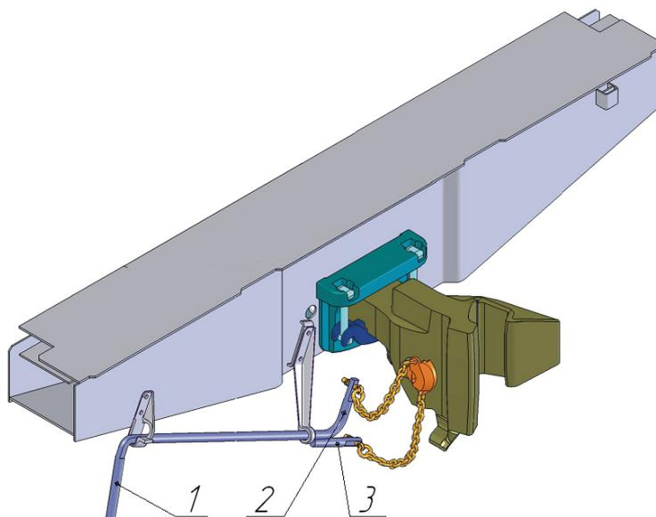
Рисунок 2.75 – Расцепной привод автосцепки
