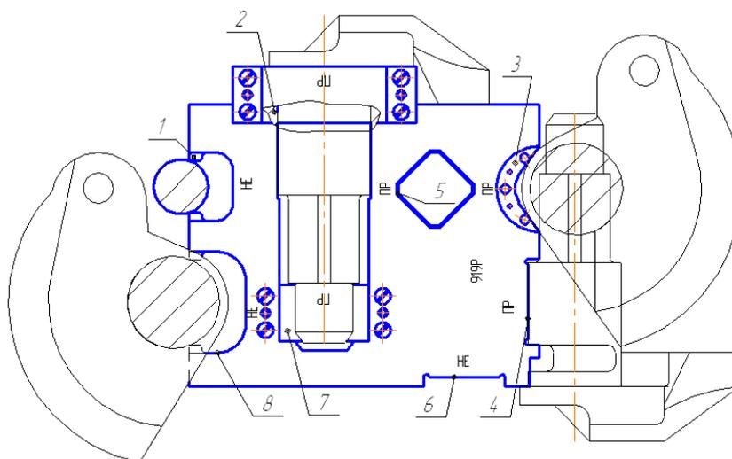
Рисунок 2.34 - Проверка валика подъемника шаблоном 919р
