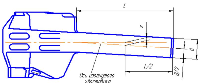
Рисунок 2.19 - Разметка корпуса автосцепки для определения изгиба хвостовика в горизонтальной (а) и вертикальной (б) плоскостях:
