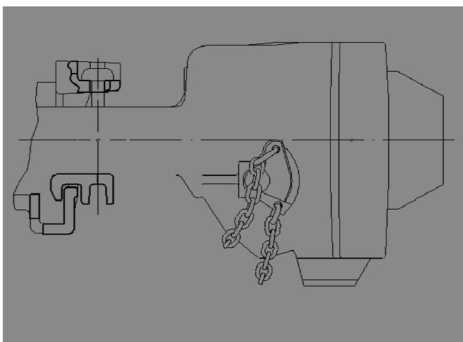
Рисунок 2.74 - Способ измерения высоты автосцепки над головками рельсов
