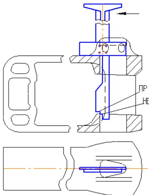
Рисунок 2.59 - Проверка длины тягового хомута (а) и высоты потолка проема в головной части тягового хомута (б) шаблоном 920р-1
