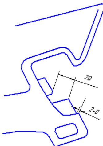
Рисунок 2.41 - Положение замка и замкодержателя в собранной автосцепке
