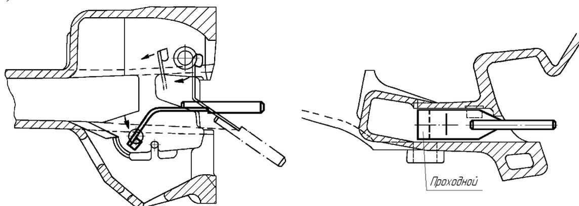
Рисунок 2.9 - Проверка ширины кармана корпуса автосцепки:
