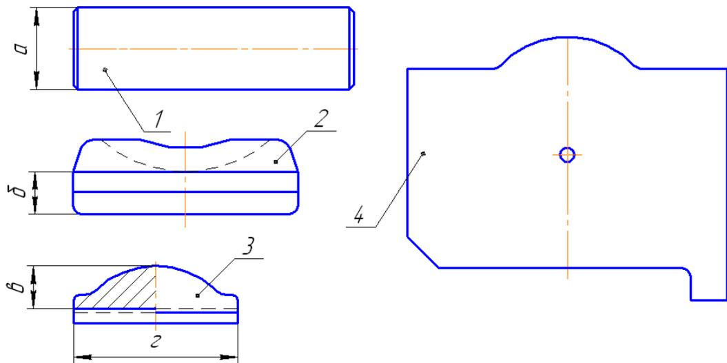
Рисунок 2.65 - Детали упряжного устройства автосцепки СА-3М
