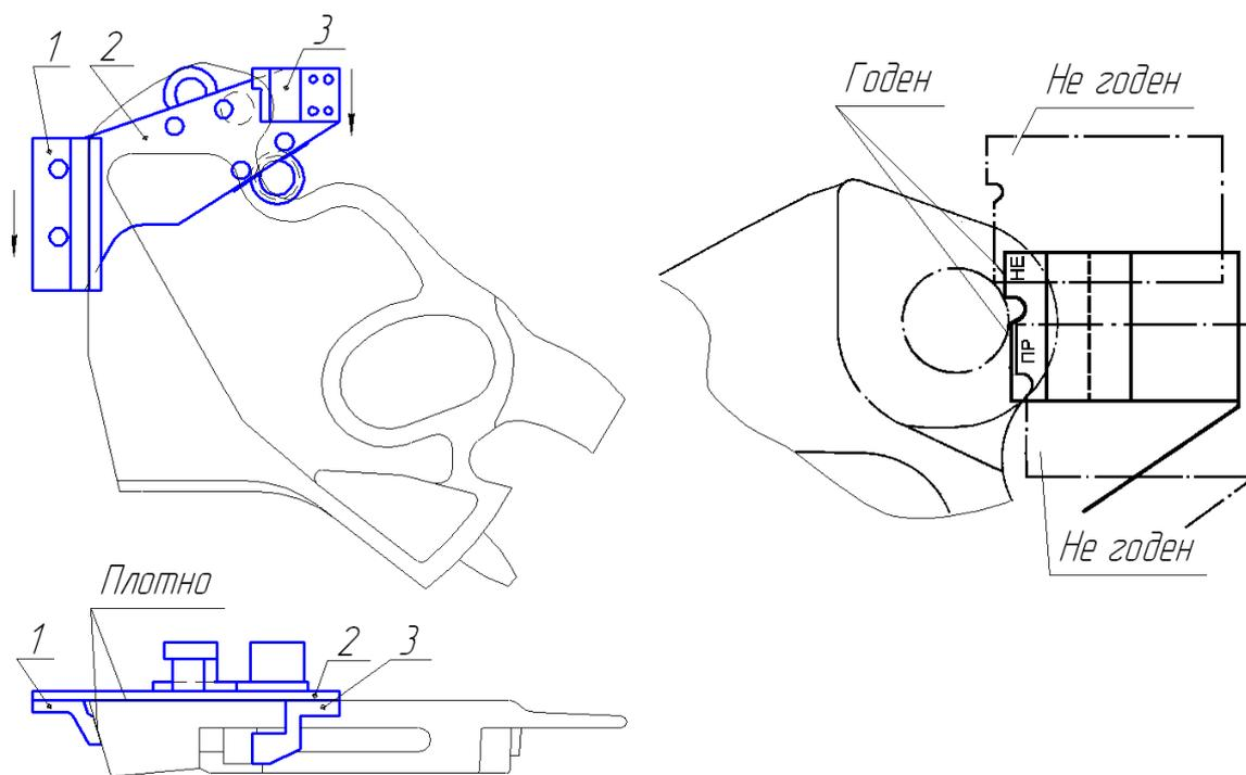
Рисунок 2.24 - Проверка положения шипа замка шаблоном 833р
