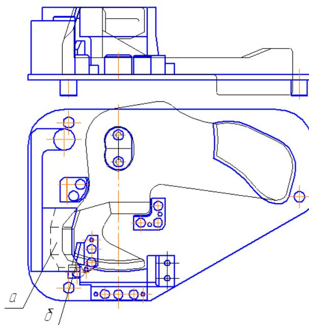
Рисунок 2.31 - Проверка наружного очертания замкодержателя шаблоном 916р
