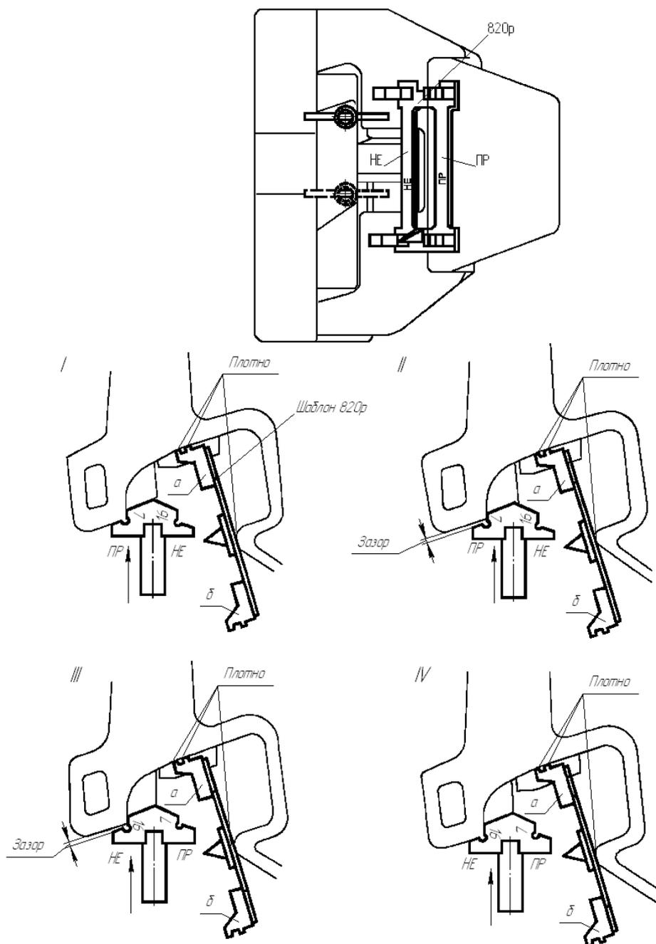
Рисунок 2.40 - Проверка величины отхода замка от кромки малого зуба шаблонами 787p и 820p
