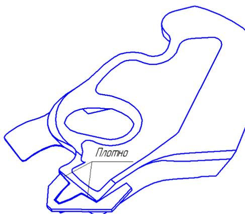
Рисунок 2.27 - Проверка направляющего зуба замка шаблоном 943р
