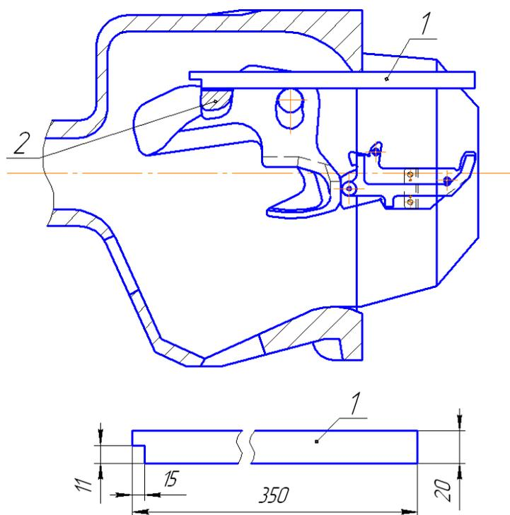
Рисунок 3.3 - Проверка возвышения противовеса замкодержателя над полочкой
