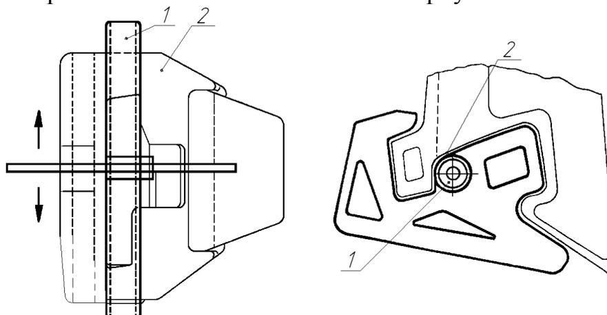
Рисунок 2.3 - Проверка контура зацепления корпуса автосцепки проходным шаблоном 827р
