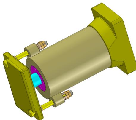
Рисунок 2.54 – Поглощающий аппарат АПЭ-90-А
