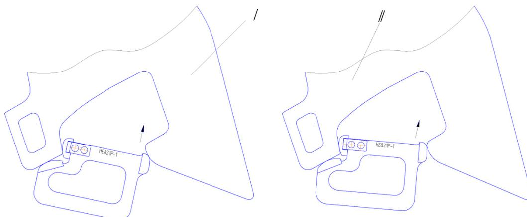
Рисунок 2.1 - Проверка ширины зева корпуса автосцепки шаблоном 821р-1:
