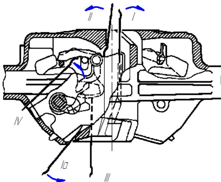
Рисунок 4.1 - Положения ломика при проверке автосцепки
