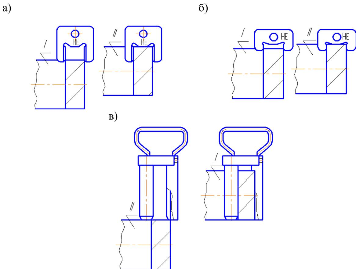
Рисунок 2.18 - Проверка толщины перемычки хвостовика автосцепки СА-3: а-непроходным шаблоном 897р-1 или 898р-1; б- непроходным шаблоном 900р-1; в- проходным шаблоном 46г (*I* – перемычка годна; *II* - перемычка негодна)
