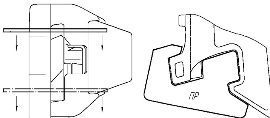
Рисунок 2.35 - Проверка контура зацепления собранной автосцепки шаблоном 828р
