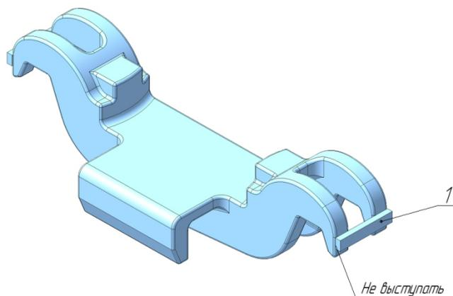
Рисунок 2.68 - Расположение планки между крюкообразными опорами центрирующей балочки
