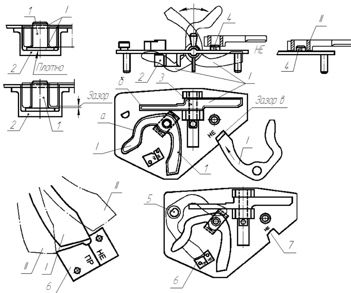
Рисунок 2.32 - Проверка предохранителя замка шаблоном 800р-1:
