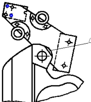
Рисунок 2.26 - Проверка износа прилива для шипа шаблоном 833р
