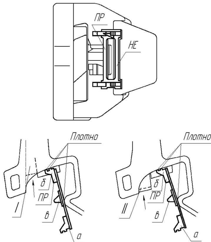
Рисунок 2.37 - Выявление возможности преждевременного включения предохранителя шаблоном 820р
