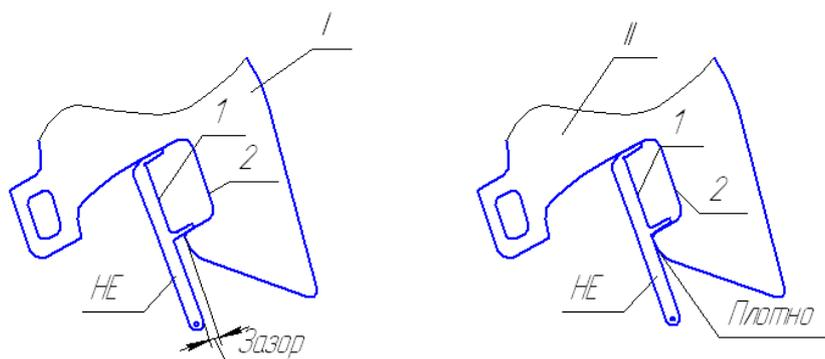
Рисунок 2.2 - Проверка шаблонами 892р, 893р, 884р: а-длины малого зуба; б-расстояния между ударной стенкой зева и тяговой поверхностью большого зуба; I-корпус годен; II- корпус негоден (внутренняя грань I шаблона должна быть параллельна боковой поверхности 2 большого зуба)
