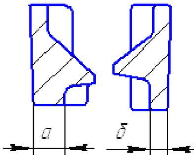
Рисунок 2.45 - Фрикционные клинья поглощающих аппаратов
