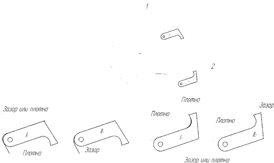
Рисунок 2.7 - Проверка закруглений углов зева *I*<sub>1</sub> и малого зуба *2* шаблоном 822р: *I*<sub>1</sub> – угол зева годен, *II*<sub>1</sub> – угол зева негоден; *I*<sub>2</sub> – угол малого зуба годен; *II*<sub>2</sub> – угол малого зуба негоден
