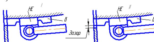
Рисунок 2.4 - Проверка ударных поверхностей зева и малого зуба автоцепки профильной планкой 914р/24-1м шаблона 914р-м
