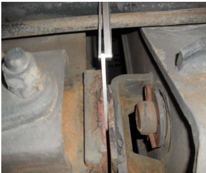
Рисунок 4 – Суммарный зазор между вертикальными скользящими (с одной стороны у тележки) у тележки типа ЦМВ Дессау - не более 16 мм
