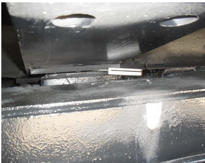
Рисунок 3 – Суммарный зазор между горизонтальными скользунами с обеих сторон тележек типа КВЗ-И2 и типа ЦМВ – Дессау - не более 6 или не менее 2 мм
