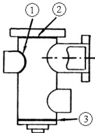
Рисунок 4.9.2 – Дефекты грязевика котла, ремонтируемые сваркой
