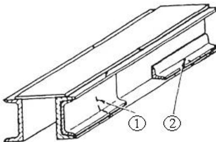
Рисунок 4.7.1 – Дефекты балки хребтовой, ремонтируемые сваркой или наплавкой
