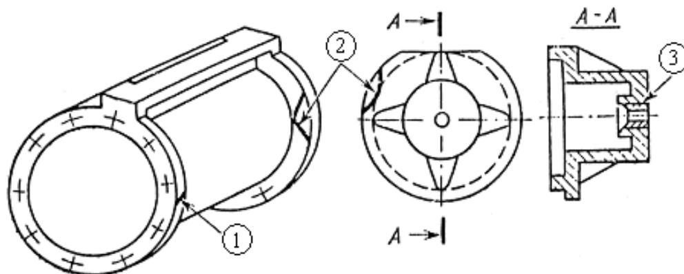
Рисунок 4.5.2 – Дефекты тормозного цилиндра марки 501Б, ремонтируемые сваркой
