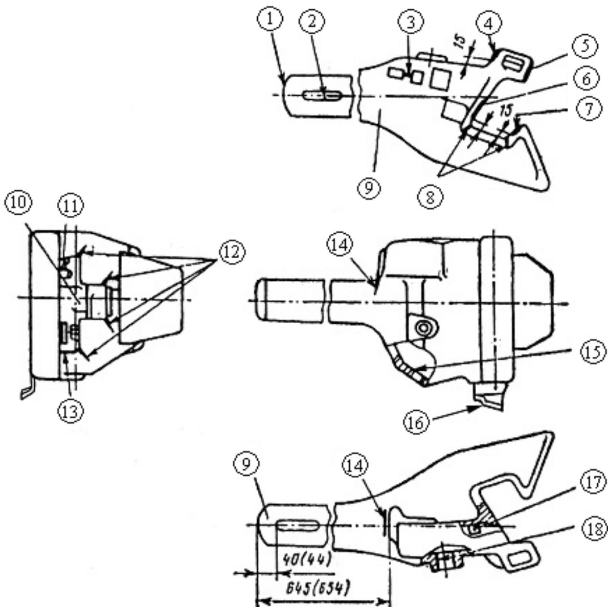
Рисунок 4.6.1 – Дефекты корпуса автосцепки, ремонтируемые сваркой или наплавкой
