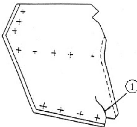
Рисунок 4.8.7 – Дефект щита подножки, ремонтируемый сваркой
