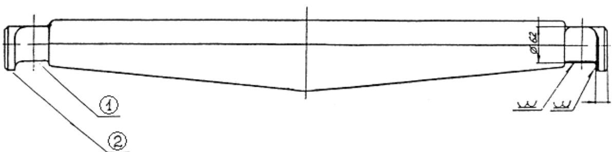
Рисунок 4.2.14 – Изношенные поверхности опорной балки тележки вагона ЦВМ
