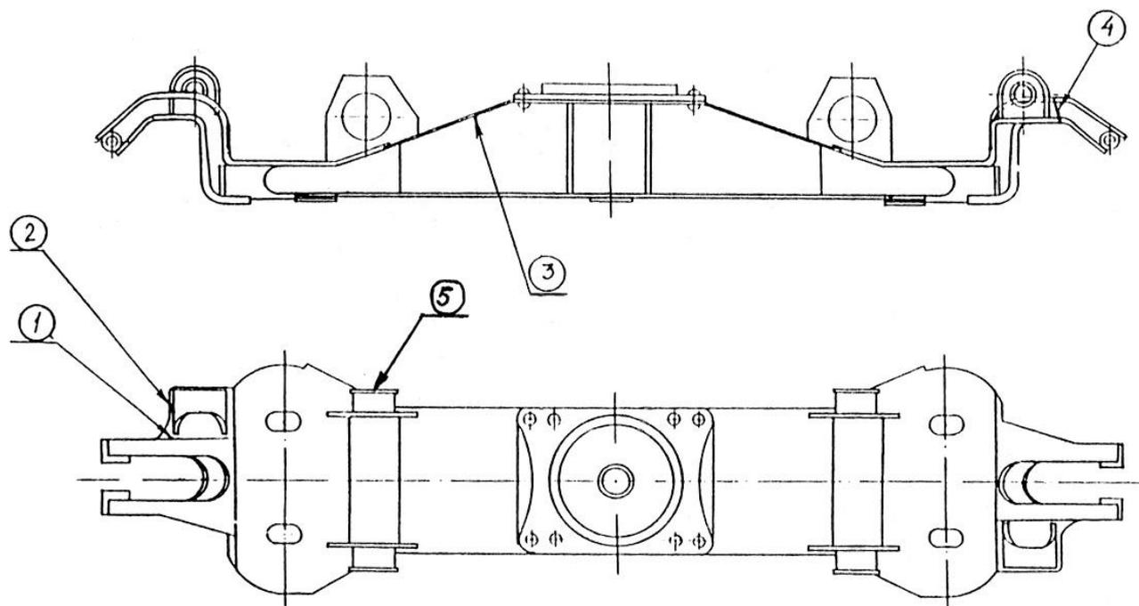
Рисунок 4.1.12 – Основные дефекты балки надрессорной тележки КВЗ-ЦНИИ, ремонтируемые сваркой или наплавкой
