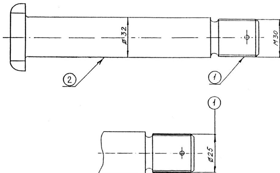
Рисунок 4.2.2 – Основные дефекты болта гасителя колебаний, ремонтируемые сваркой или наплавкой
