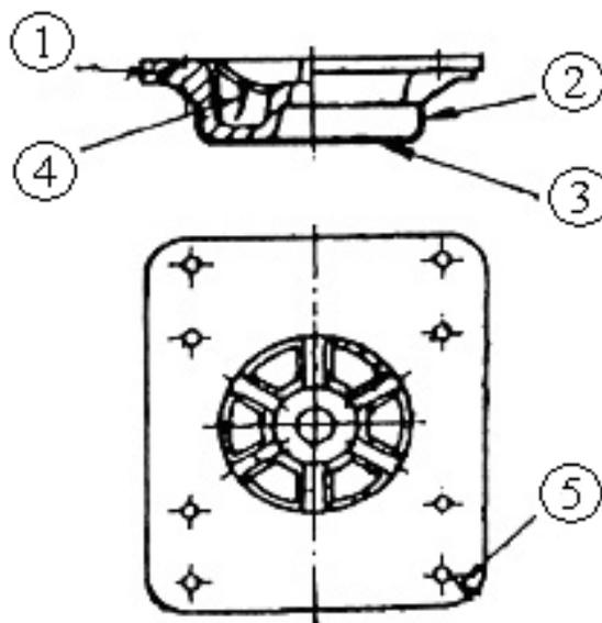
Рисунок 4.7.4 – Дефекты пятника, ремонтируемые сваркой или наплавкой
