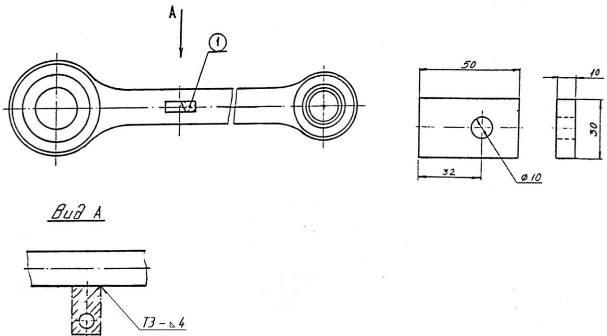
Рисунок 4.5.5 – Дефекты подвески башмака, ремонтируемые сваркой или наплавкой
