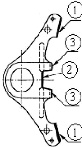
Рисунок 4.5.4 – Поверхности износа башмака тормозной колодки
