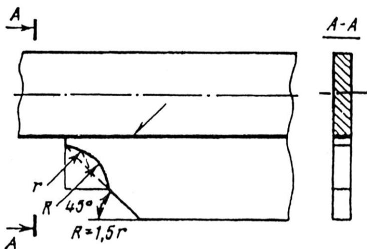
Рисунок 3.4.2 – Приварка косынки к горизонтальному листу ответственного элемента
