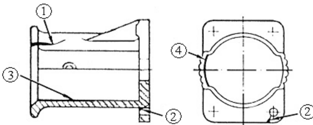
Рисунок 4.6.18 – Дефекты стакана буферного, ремонтируемые сваркой или наплавкой
