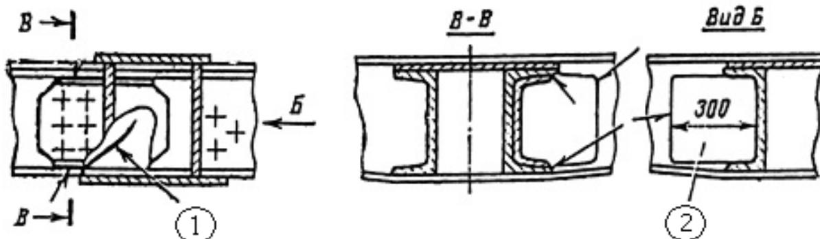
Рисунок 4.7.3 – Отремонтированная хребтовая балка в случае, когда трещина с горизонтальной полки распространялась на вертикальную
