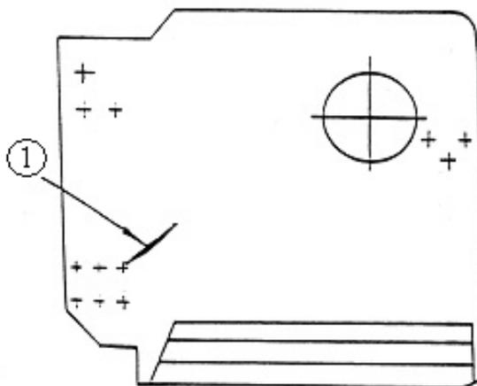
Рисунок 4.8.8 – Дефект площадки откидной, ремонтируемы сваркой
