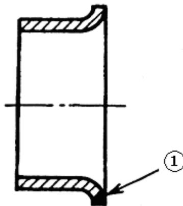
Рисунок 4.5.10 – Дефект втулки упорной регулятора тормозной рычажной передачи, ремонтируемый сваркой
