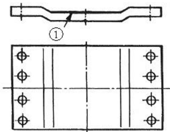
Рисунок 4.6.15 – Поверхность износа планки поддерживающей
