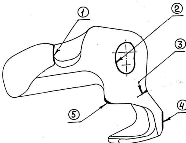
Рисунок 4.6.3 – Дефекты замкодержателя автосцепки, ремонтируемые сваркой или наплавкой
