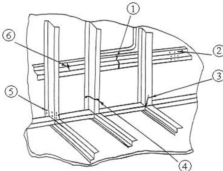
Рисунок 4.8.1 – Дефекты каркаса кузова, ремонтируемые сваркой или наплавкой
