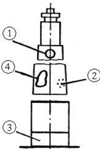
Рисунок 4.9.1 – Дефекты котла водяного отопления, ремонтируемые сваркой или наплавкой
