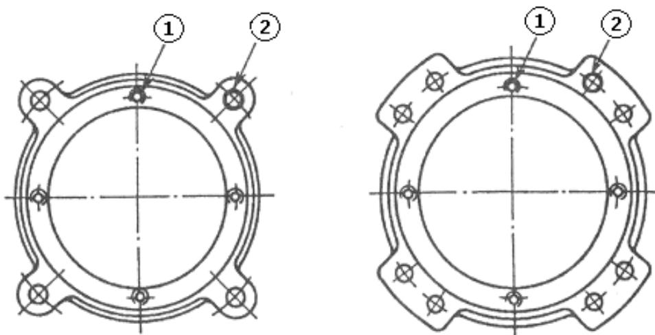
Рисунок 4.4.3 – Дефекты крепительных крышек, ремонтируемые сваркой
