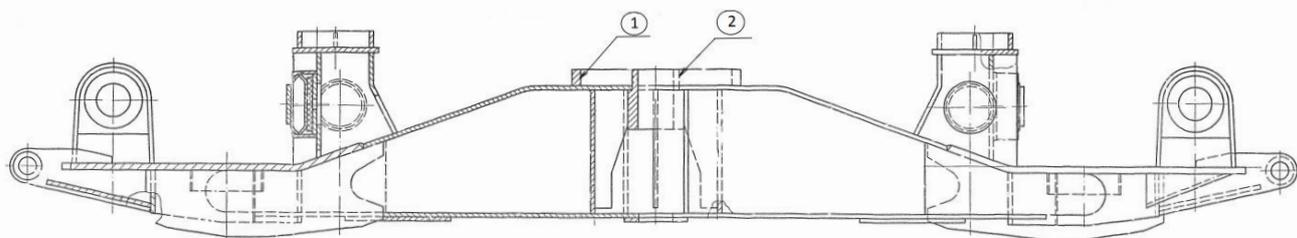
Рисунок 4.1.13 – Основные дефекты балки надрессорной тележки ТВЗ-ЦНИИ-М, ремонтируемые сваркой или наплавкой
