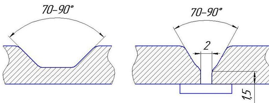
Рисунок 3.12.3.1 – Профили разделки дефекта под пайкосварку
