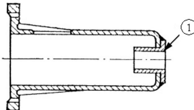
Рисунок 4.6.20 – Корпус амортизатора
