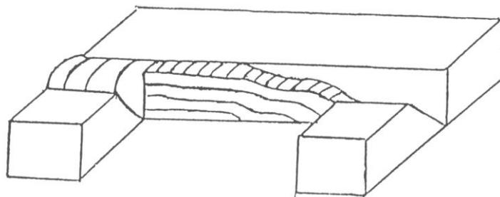
Рисунок 3.23.1 – Сварка каскадом
