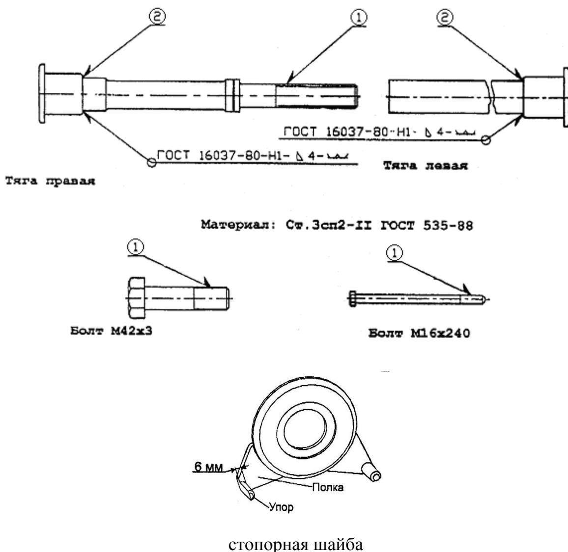
Рисунок 4.2.16 – Дефекты деталей поводка ООО «ИВП-ЭД» (черт. К-0493.00.00.000/3), ремонтируемые сваркой или наплавкой
