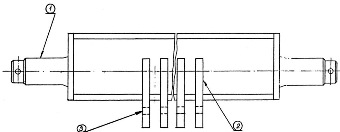
Рисунок 4.5.3 – Дефекты траверсы, ремонтируемые сваркой или наплавкой
