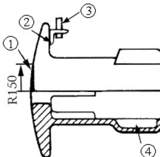
Рисунок 4.6.19 – Дефекты буферного стержня, ремонтируемые сваркой или наплавкой
