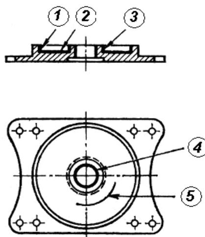
Рисунок 4.1.15 – Основные дефекты подпятника, ремонтируемые сваркой или наплавкой
