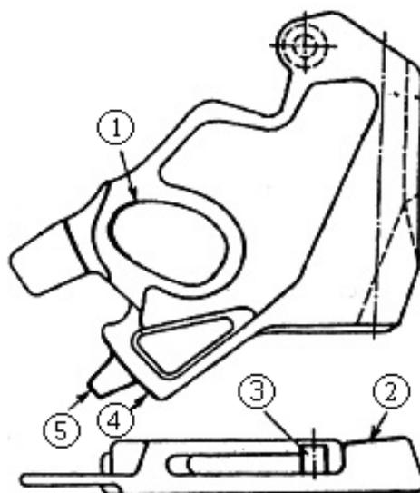
Рисунок 4.6.2 – Дефекты замка автосцепки, ремонтируемые наплавкой
