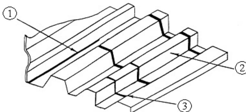
Рисунок 4.8.3 – Дефекты металлического пола вагона, ремонтируемые сваркой
