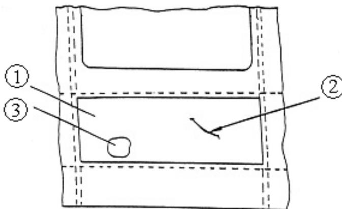
Рисунок 4.8.2 – Дефекты металлической обшивки стен, ремонтируемые сваркой
