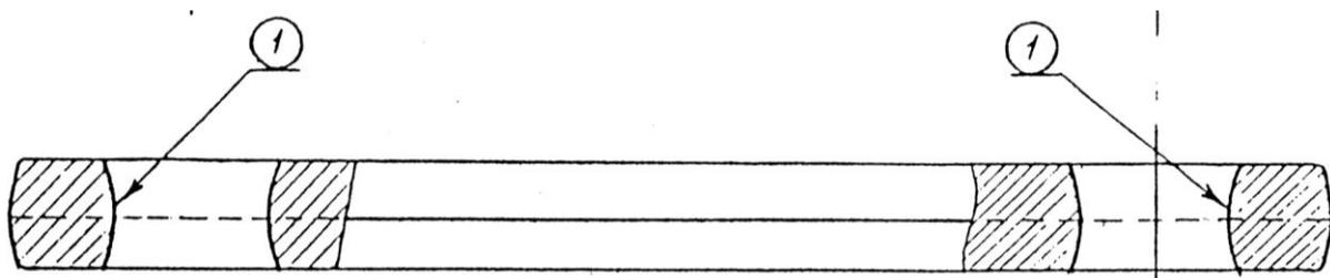
Рисунок 4.2.9 – Поверхности износа тяги подвески тележек типа ЦМВ
