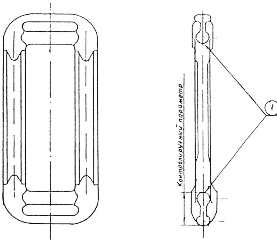
Рисунок 4.2.10 – Поверхности износа серьги
