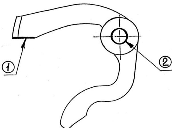
Рисунок 4.6.4 – Поверхности износа предохранителя замка автосцепки
