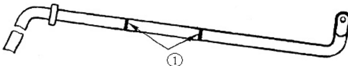
Рисунок 4.6.17 – Дефект рычага расцепного, ремонтируемый сваркой
