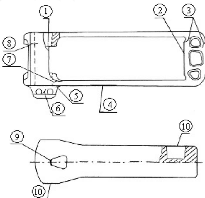
Рисунок 4.6.8 – Дефекты хомута тягового, ремонтируемые сваркой или наплавкой
