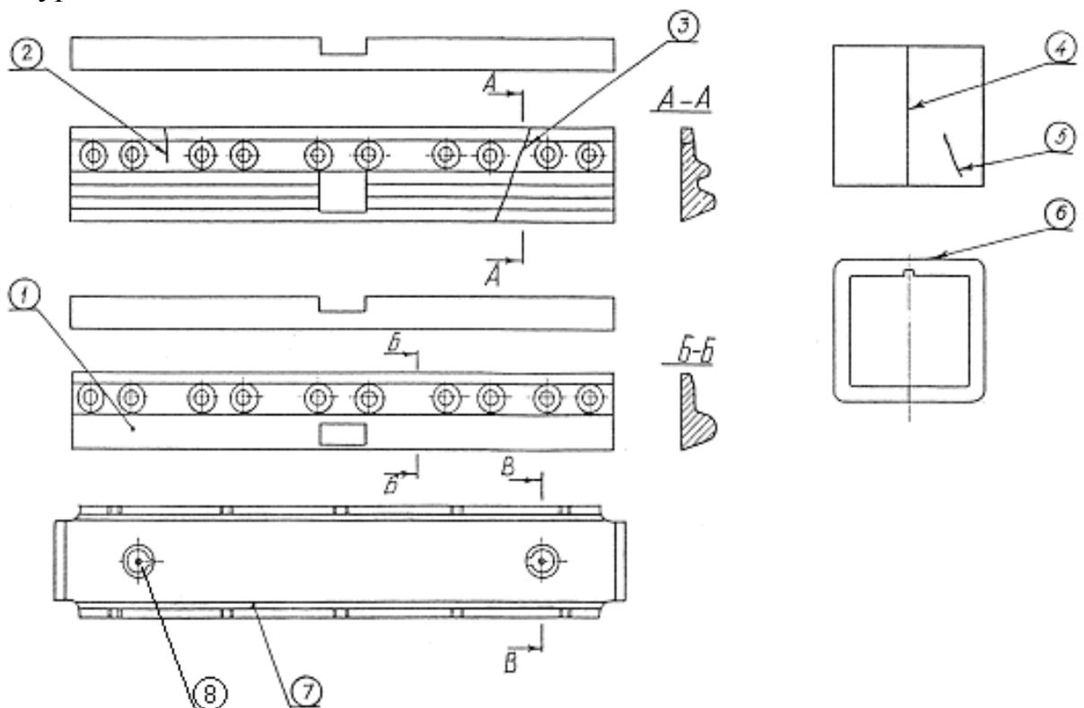
Рисунок 4.2.15 – Основные дефекты деталей центрального рессорного подвешивания, ремонтируемые сваркой или наплавкой
