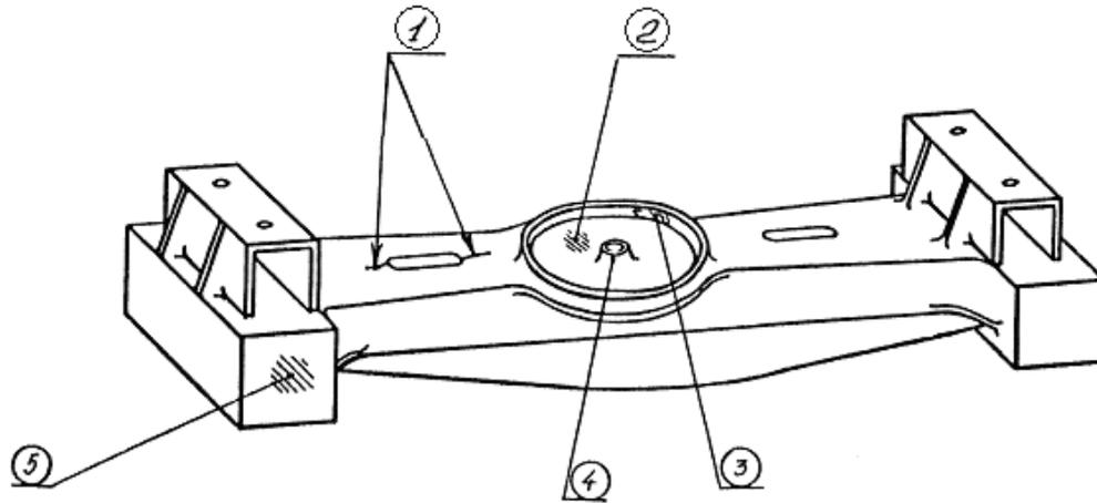
Рисунок 4.1.8 – Основные дефекты литой балки надрессорной ЦМВ, ремонтируемые сваркой или наплавкой
