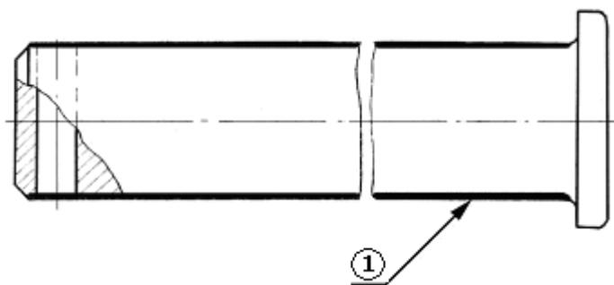
Рисунок 4.5.8 – Дефект валика тормозной рычажной передачи, ремонтируемый наплавкой
