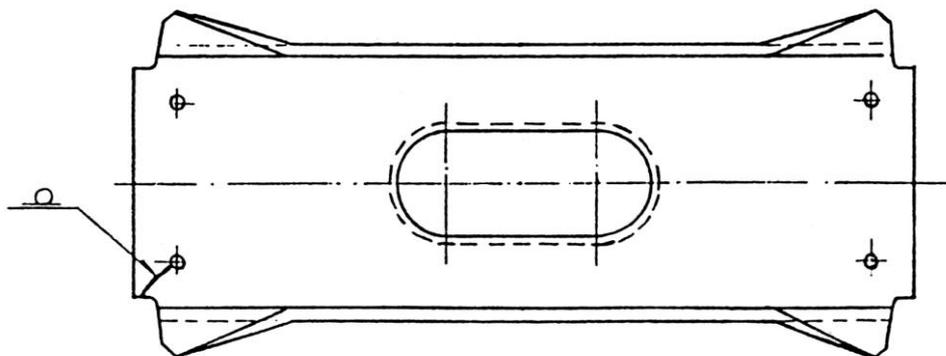
Рисунок 4.1.10 – Основные дефекты балки поддресорной тележки ЦМВ, ремонтируемые сваркой или наплавкой
