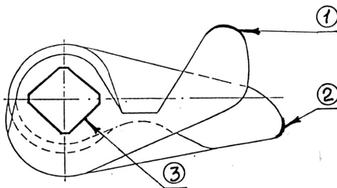
Рисунок 4.6.5 – Поверхности износа подъемника замка автосцепки
