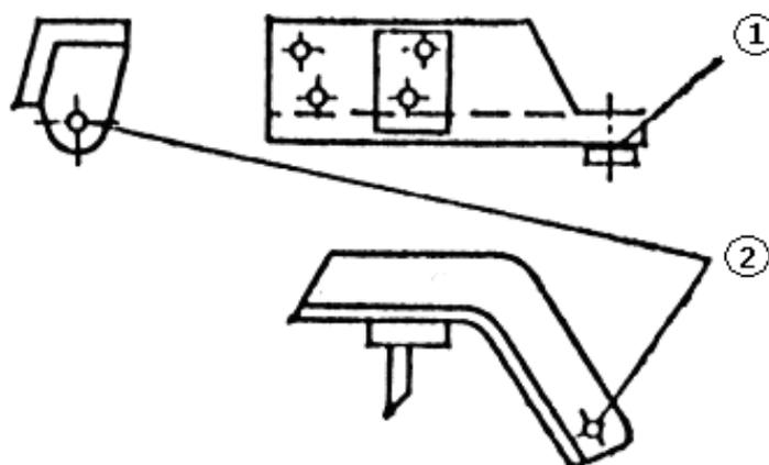
Рисунок 4.5.6 – Дефекты кронштейна, ремонтируемые сваркой
