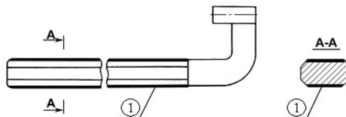
Рисунок 4.6.22 – Дефекты клина, ремонтируемые наплавкой
