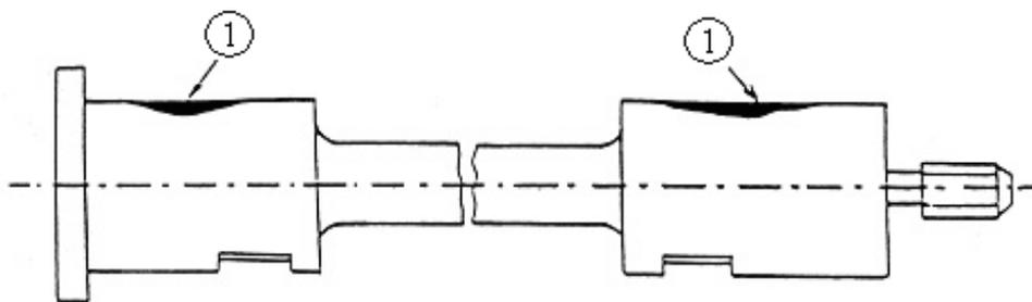
Рисунок 4.8.6 – Дефект вала откидной площадки, ремонтируемый наплавкой
