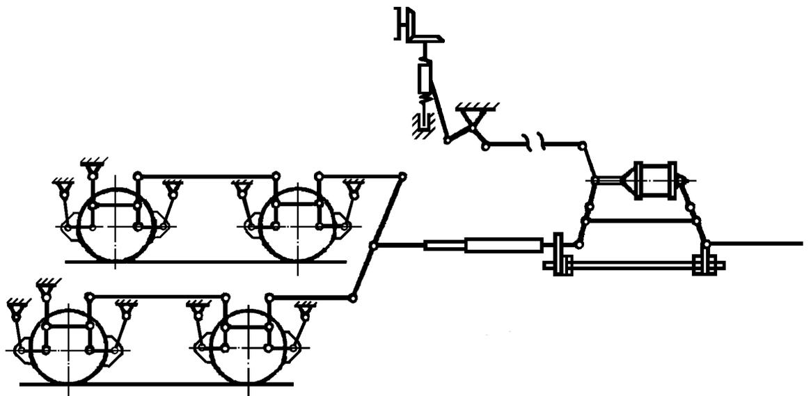
Рисунок А.8 – Схема тормозной рычажной передачи рефрижераторного вагона
