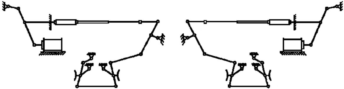
Рисунок А.7 – Схема тормозная рычажная вагона - хоппера с раздельным торможением
