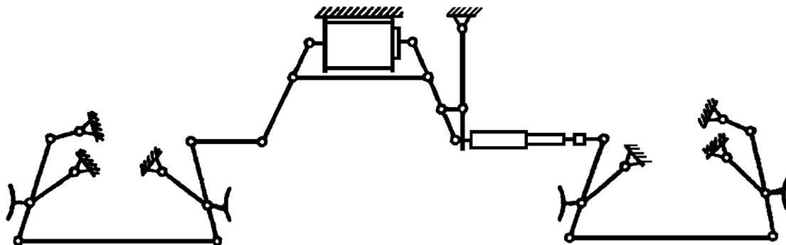
Рисунок А.1 – Схема тормозной рычажной передачи грузового четырехосного вагона
