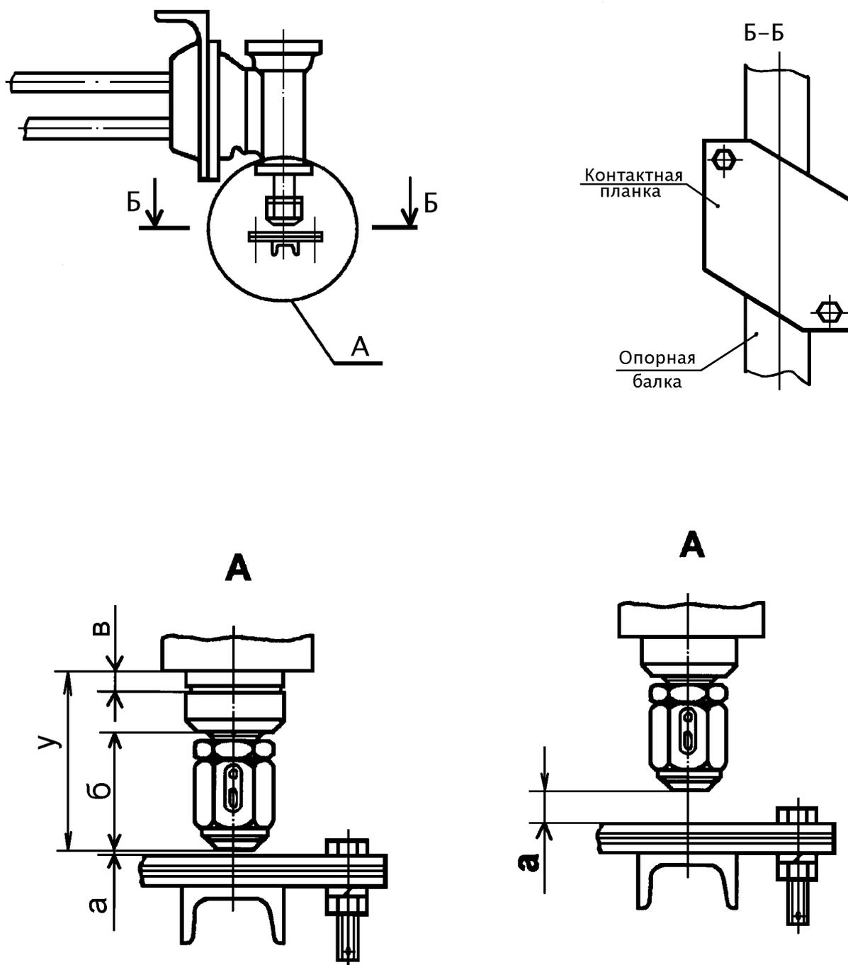
Авторезим установлен правильно – кольцевая проточка на вилке видна, между упором и контактной планкой присутствует зазор от 1 до 3 мм
