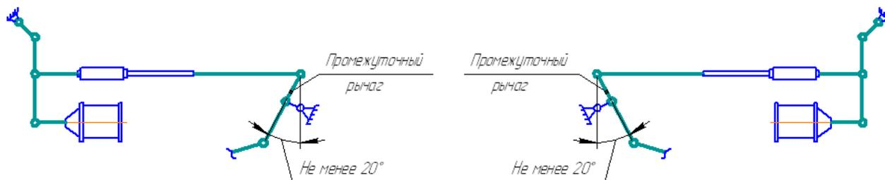
Рисунок 17 – положение промежуточных рычагов при полном служебном торможении на вагонах с раздельным торможением
