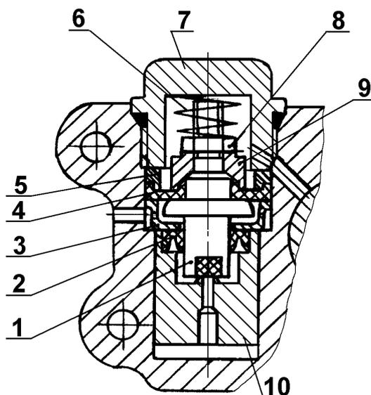
1 – клапан 483.080; 2 – манжета 305.156; 3 – упор 483.001; 4 – диафрагма 483.005; 5 – кольцо 483.016; 6 – пружина 483.025-2; 7 – заглушка 483.007; 8 – гайка 2М6-6Н.5.019 ГОСТ 5915; 9 – шайба 483.006; 10 – втулка 483.032
