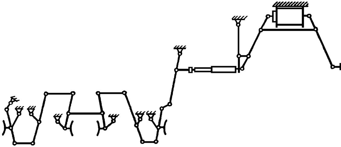
Рисунок А.5 – Схема тормозной рычажной передачи шестиосного вагона-самосвала
