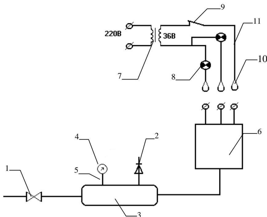
1- кран разобщительный ; 2-; 3-резервуар объемом 1,5 л.; 4-манометр; 5-трубопровод; 6-сигнализатор давления; 7 трансформатор; 8-лампа сигнальная; 9-тумблер; 10-зажим; 11-провод.
