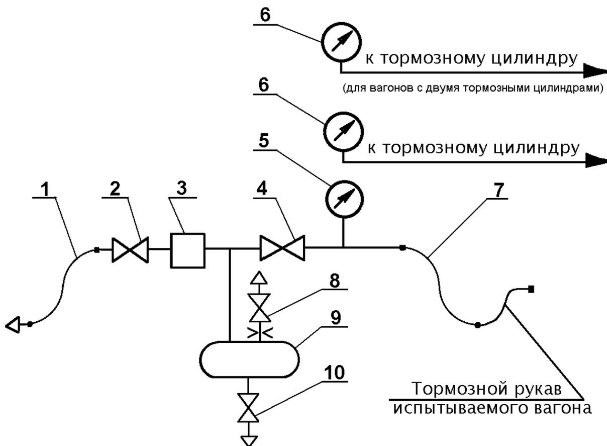
1, 7 – соединительные рукава; 2, 4 – разобщительные краны или заменяющие их устройства; 3 – кран машиниста (блок управления); 5, 6 – манометры; 8 – разобщительный кран с дроссельным отверстием Ø2 мм или заменяющее его устройство; 9 – магистральный резервуар; 10 – водоспускной кран
