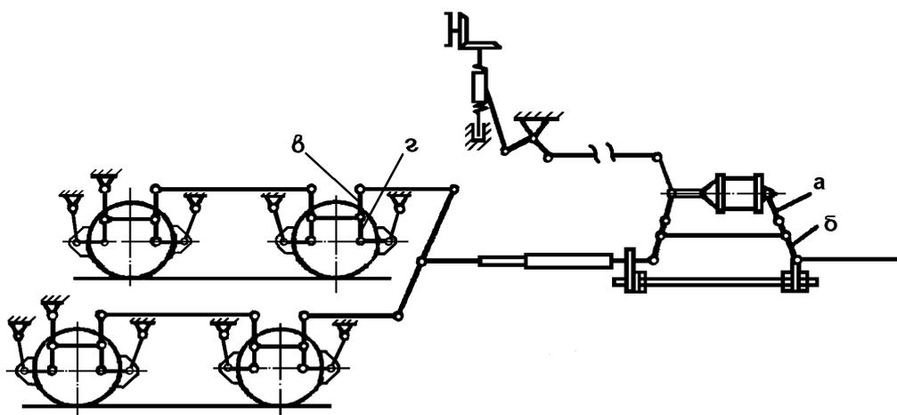
Рисунок Б.1 – Схема тормозной рычажной передачи пассажирского четырехосного цельнометаллического вагона
