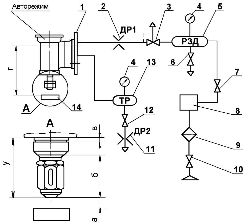
1 – привалочный фланец с прижимом для крепления авторежима; 2 - дроссель  $\varnothing$  3 мм; 3 – кран трехходовой или заменяющее его устройство; 4 – контрольно-измерительный прибор для измерения давления (манометр); 5 – резервуар задатчика давления; 6,12 – водоспускной кран; 7,10 – разобшительный кран или заменяющее его устройство; 8 – задатчик давления; 9 – фильтр; 11 – дроссель  $\varnothing$  1 мм; 13 – тормозной резервуар; 14 – механизм-поднятия упора авторежима
