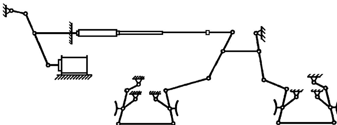
Рисунок А.2 – Схема тормозной рычажной передачи вагона – хоппера для перевозки зерна (цемента, минеральных удобрений)
