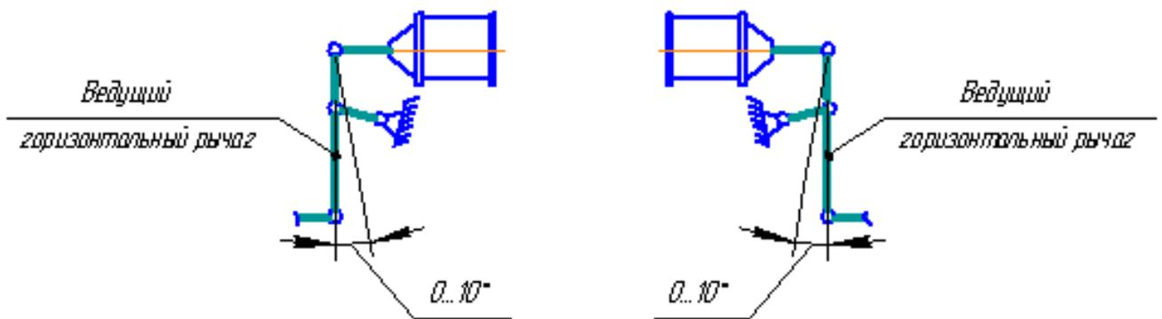
Рисунок 15 – Положение ведущих горизонтальных рычагов при полном служебном торможении на вагонах с отдельным торможением
