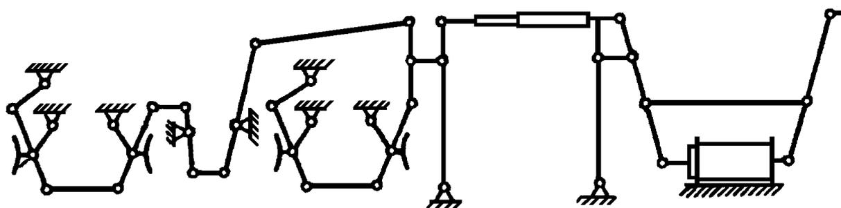
Рисунок А.4 – Схема тормозной рычажной передачи восьмиосного вагона-цистерны
