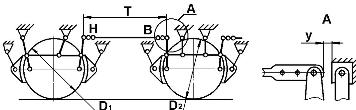
Рисунок 19 – Схема тормозной рычажной передачи тележки пассажирского вагона.
