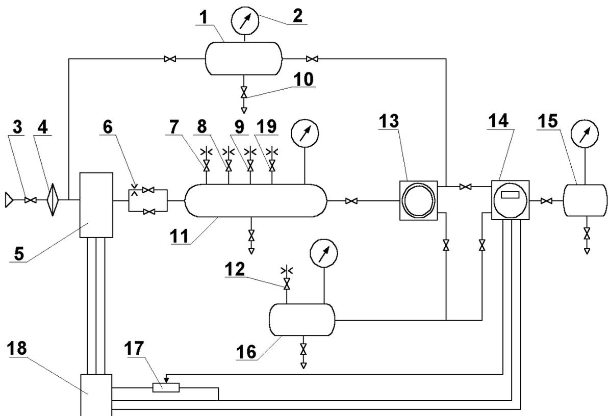
1 - запасный резервуар; 2 - манометр; 3 - разобцительный кран; 4 - фильтр; 5 - блок крана машиниста или заменяющее устройство; 6, 7, 8, 9, 12, 19 - дроссельные отверстия диаметром соответственно 0,8; 5; 8; 0,9; 1 и 2 мм; 10 - водоспускной кран; 11 - магистральный резервуар; 13, 14 - привалочные фланцы соответственно для воздухораспределителя и электровоздухораспределителя; 15 - рабочая камера; 16 - тормозной резервуар; 17-реостат; 18 - блок электропитания.
