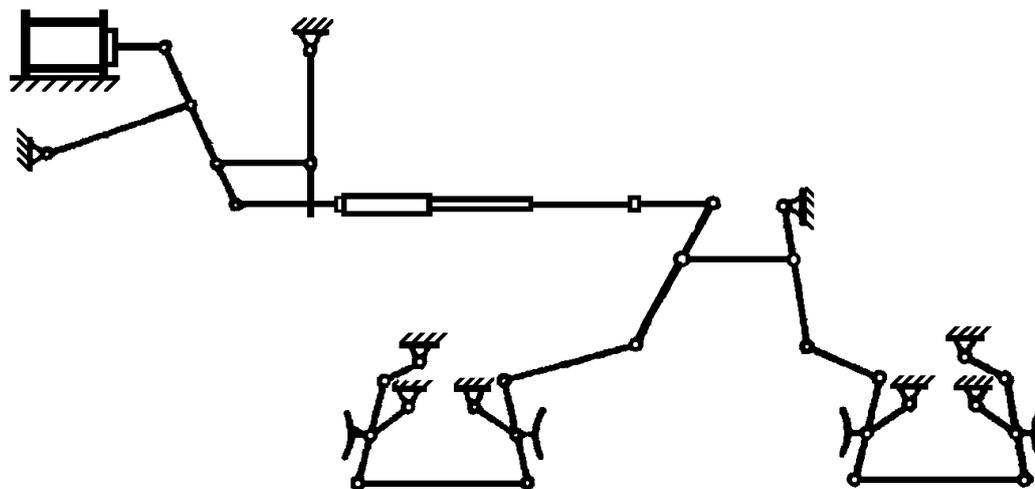
Рисунок А.3 – Схема тормозной рычажной передачи вагона – хоппера для перевозки окатышей
