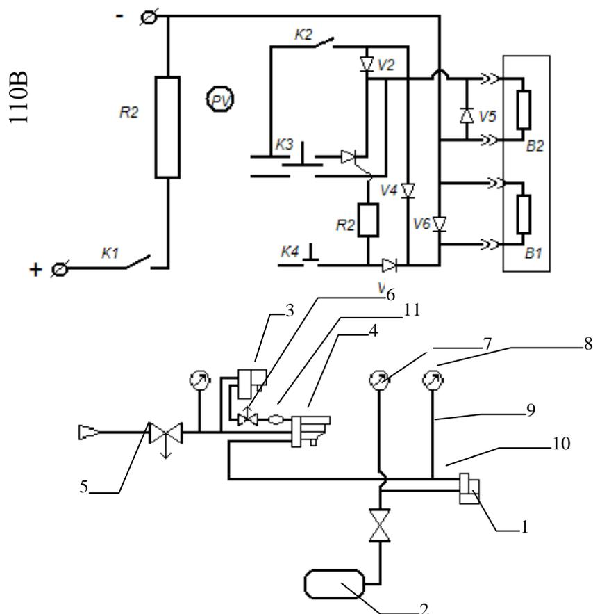
1–клапан сбрасывающий трехпозиционный; 2–резервуар объемом 2,5 л; 3–редуктор; 4–реле давления; 5,6–кран разобщительный с атмосферным отверстием; 7,8–манометр; 9–трубопроводы ; 11–резервуар объемом 2 л
