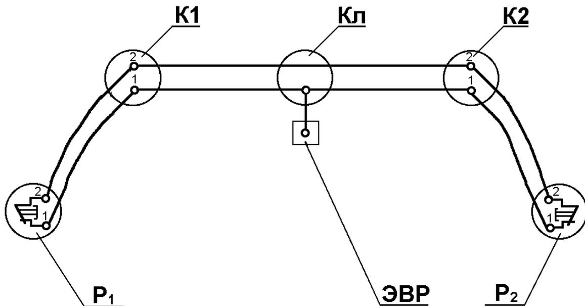
1, 2 - электрические контакты; P1, P2 - головки соединительных рукавов с электроконтактом; K1, K2 - двухтрубные клеммные коробки 316.000-8; Кл - трехтрубная клеммная коробка 317.000-8; ЭВР – электрический контакт на контактной колодке рабочей камеры (подключение электровоздухораспределителя)
