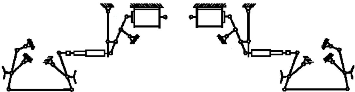
Рисунок А.6 – Схема тормозной рычажной передачи четырехосного вагона с разделённым торможением
