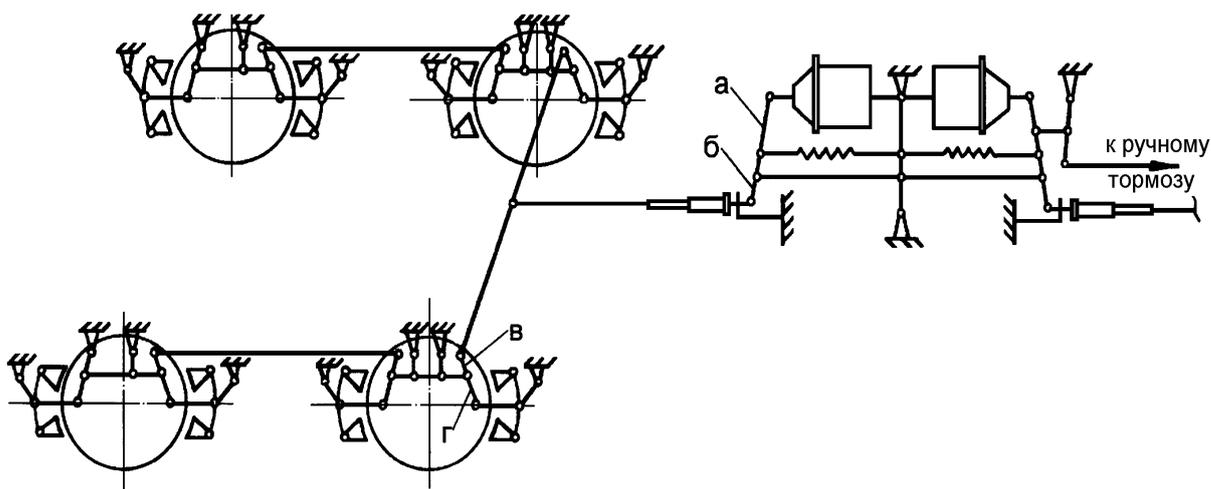
Рисунок Б.2 – Схема тормозной рычажной передачи пассажирского вагона международного сообщения габарита 03-Т (РИЦ) с тормозом КЕ<sub>с</sub>
