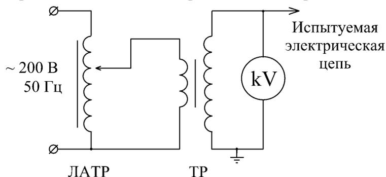
ЛАТР – лабораторный автотрансформатор; ТР – повышающий трансформатор;
