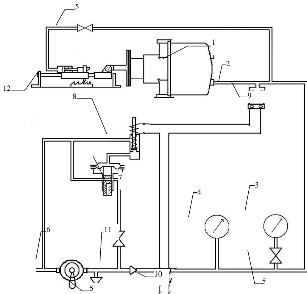
1–испытываемый ТЦР со встроенным регулятором; 2–трубопровод; 3, 4–манометр; 5- кран разобщительный ; 6–кран машиниста 326С; 7–реле давления 404; 8–электропневматический вентиль; 9–датчик давления; 10–выключатель источника тока напряжением 50 В; 11–клапан выпускной одинарный; 12–устройство для фиксации упора.
