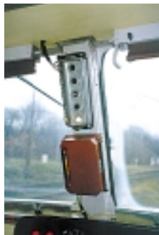
MMKTS ierīces uztvērēja bloks ar indikatoru automotrires AR2-01 kabinē.
