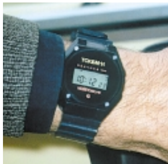
Šādi pulksteņi – MMKTS sistēmas nēsājamās daļas – kontrolē mašīnista stāvokli un pārraida informāciju par to uz borta ierīcēm.
